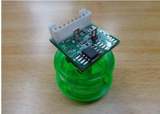
シンクロ連射30発/Sと15発/Sの任意切替え仕様で、連射スピードが確認できるLED表示付き。外付けの切替えボタンを押す度に30発/S→15発/Sを交互に切替えられます。電源投入後、約6秒間に同期信号の入力が無い場合(仕様外の同期信号もしくは未接続の場合)には約20発/Sのタイマー連射モードで動作します。
