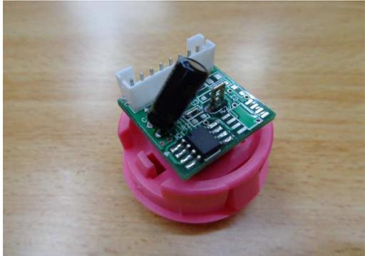
約20発/S相当の連射が可能なタイマー連射仕様。通常のアーケードゲーム筐体で使用する場合は、今付いているボタンとそのまま交換するだけで、連射ボタンに早代わり！(ボタン入力線とGND線の2本を繋ぐだけ)手間要らずのお手軽連射ボタンです。
