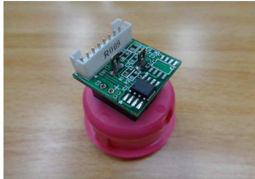
シンクロ連射30発/Sもしくは15発/Sの連射スピードが選択可能な交互連射仕様。連射タイミングの異なる「表波形」・「裏波形」の2種類が本体ボタン1つで同時に出力されますので、60発/sec連射やレバー左右交互入力連射などの用途に応用可能です。電源投入後、約6秒間に同期信号の入力が無い場合(仕様外の同期信号もしくは未接続の場合)には約20発/Sのタイマー連射モードで動作します。
